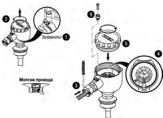
Рисунок 7.1 – Монтаж внешних электрических цепей
